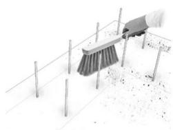
Das KRASOflex® Bentonit-Quellfugenband wird auf einem tragfähigen, trockenen, trennmittelfreien, ebenen, von losen Bestandteilen und Ansammlungen von Zementschlämme befreiten (Beton-)Untergrund befestigt.
