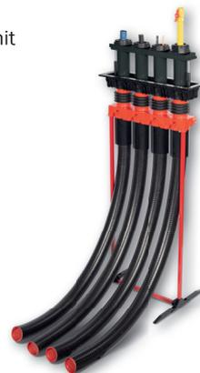
Das KRASO® Bauherren-Komfortpaket - Boden - BOX ist als Mehrsparten-Hauseinführung für einen druckwasserdichten Anschluss an die Versorgungsnetze konstruiert. Die KRASO® Vierstegdichtung schützt vor dem Eindringen des radioaktiven Radon.
