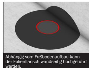
\*Sollte es aufgrund der bauseitigen Gegebenheiten nicht möglich sein, einen Abstand von 100 mm einzuhalten, ist mit dem Verarbeiter der Flächenabdichtung Rücksprache zu halten, ob die Abdichtungsbahn auch bei geringerem Abstand fachgerecht ausgeführt werden kann.
