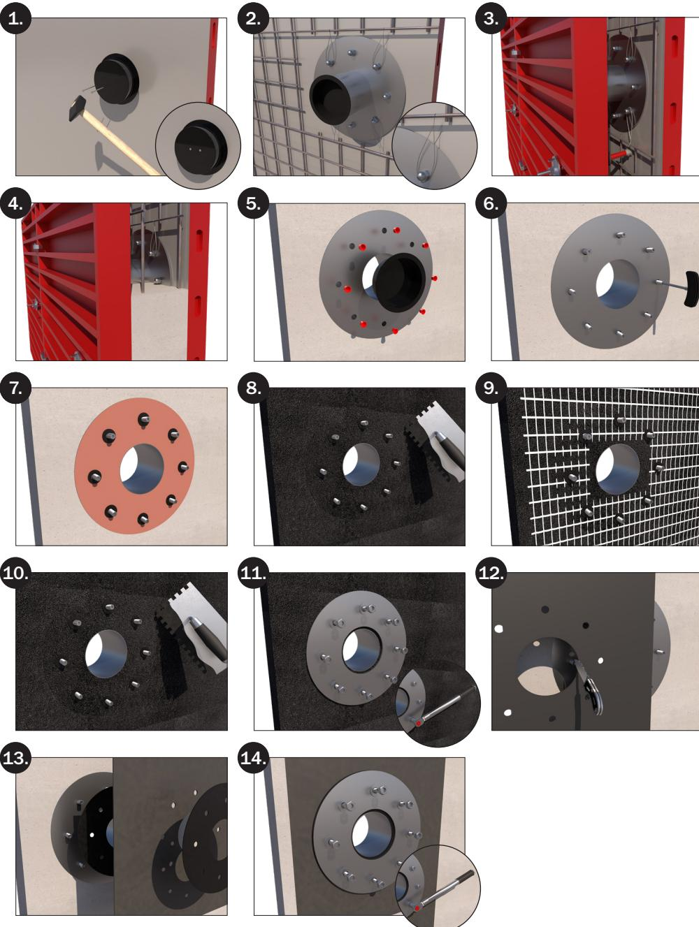
Anzugsdrehmoment des Losflansches richtet sich nach der DIN (siehe Tabelle auf der Rückseite). Drehmoment für die Zulagen laut Herstellerangaben der jeweiligen Dichtungsbahn.
