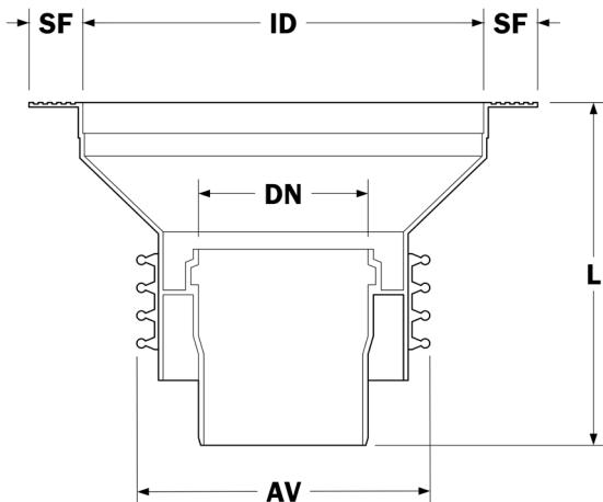
**DN** = Nennweite | **L** = Länge | **ID** = Innendurchmesser Trichter | **SF** = Spachtelflansch | **AV** = Vierstegdichtung außen
