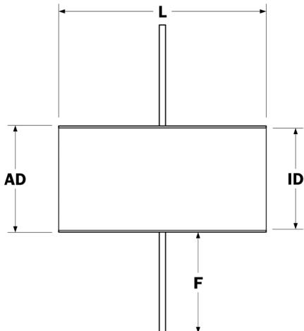
ID = Rohr innen | AD = Rohr außen | F = Mittelflansch umlaufend | L = Wandstärke
